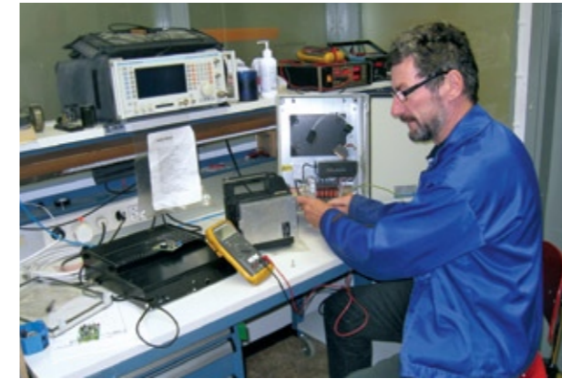
Katuvalovastaanottimen korjaus, radiopuhelin asentaja Jorma Hanhela.
